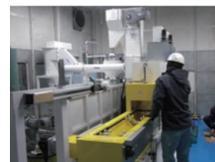
輸送コンベア付きブラスト研磨装置
