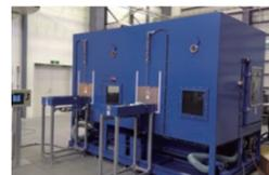
ワークの大きさ、研磨方法に応じてキャビネットを大型化
