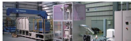
クレーン付大型ブラスト研磨装置
